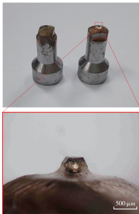
图1 钎焊磨头及金刚石磨粒
